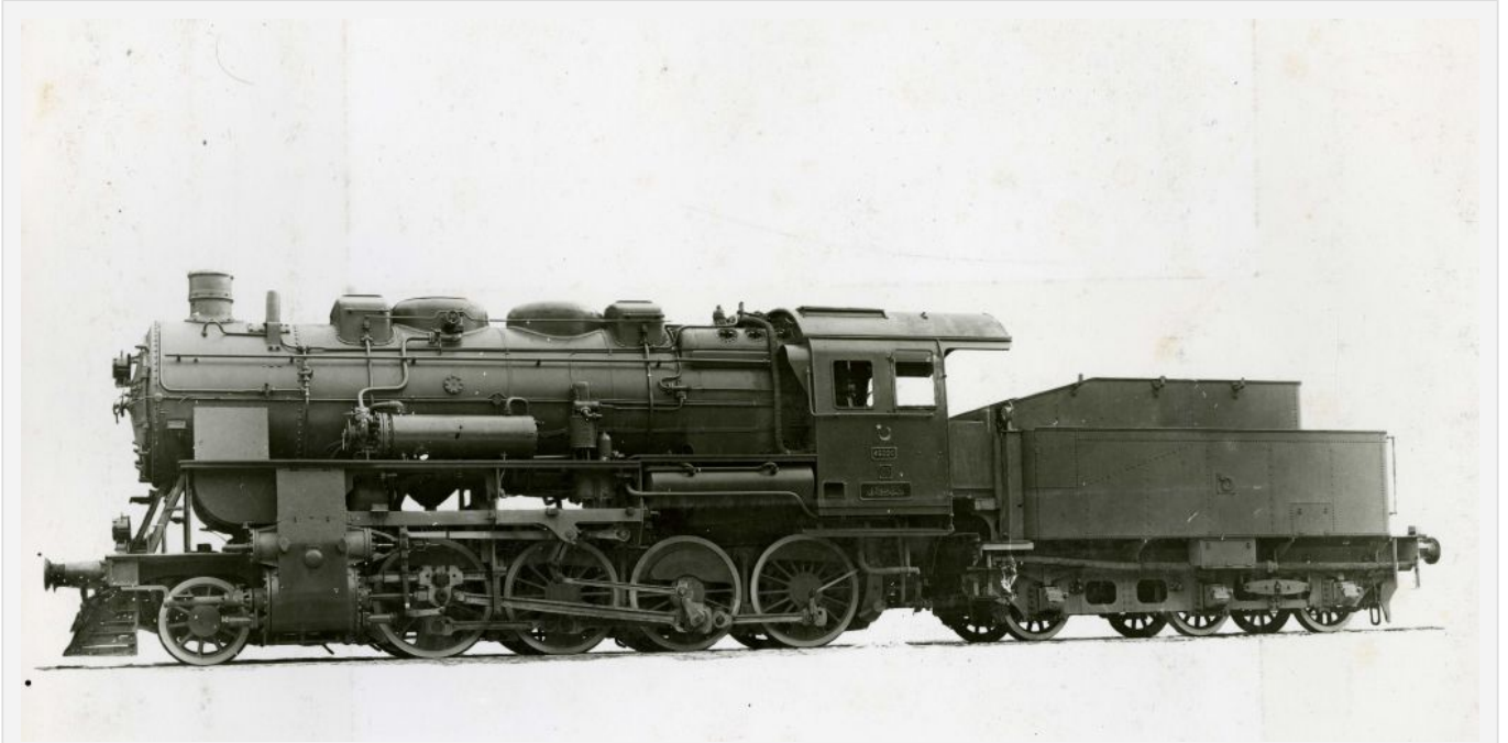
Tubize 2078 de 1928 pour le TCDD (n° 45020). Photographie d'usine, coll. Musée 'de la Porte' à Tubize. Série 2075-2082, 1928, voie 1.435, 1Dh2 ou 2-8-0, TCDD 45017-45024.
