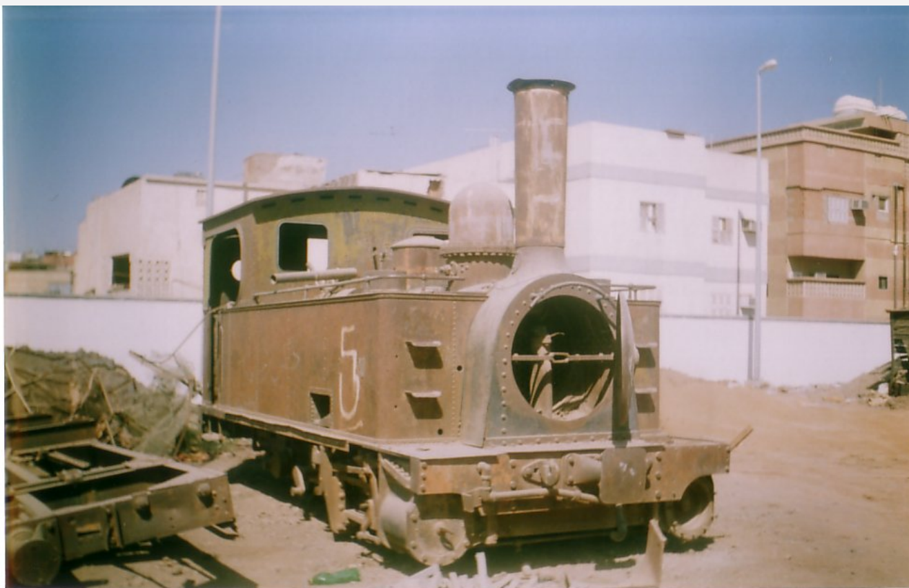
Tz 877 - Tubize type 50 - CF Damas - Hamah et Prolongements DHP 106. La cheminée n'est plus d'origine !
