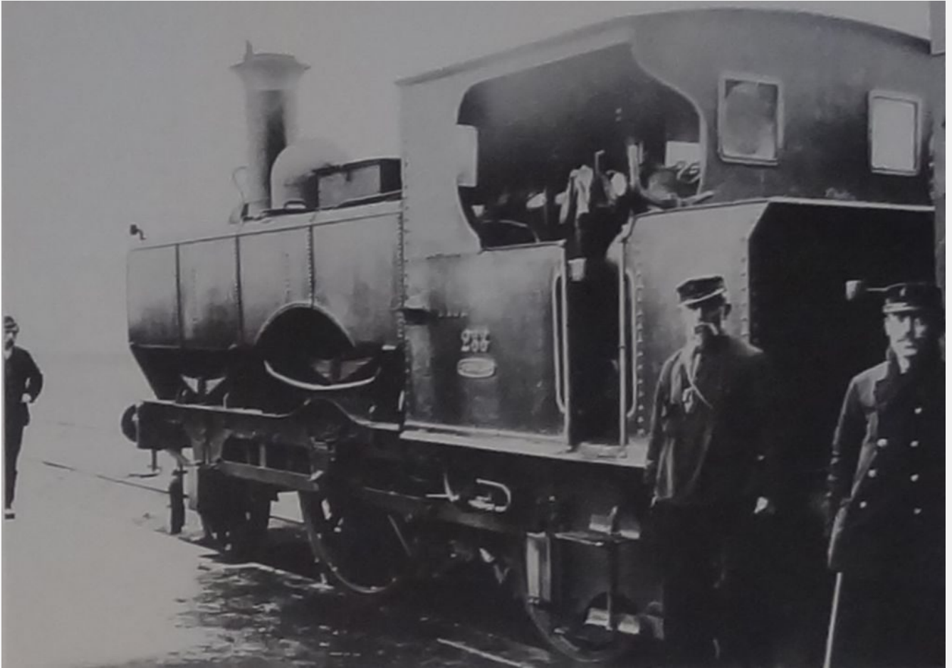
Locomotive EB 233 (Tubize, 1855), photographée vers 1895 lorsqu'elle était basée à Saint-Ghislain. Tendérisée et dotée d'un foyer Belpaire à Malines, elle fut ensuite assimilée aux machines du type 8. Photo coll. Cresens, tirée de Ph. Dambly, Vapeur en Belgique, t. 1, p. 83.
