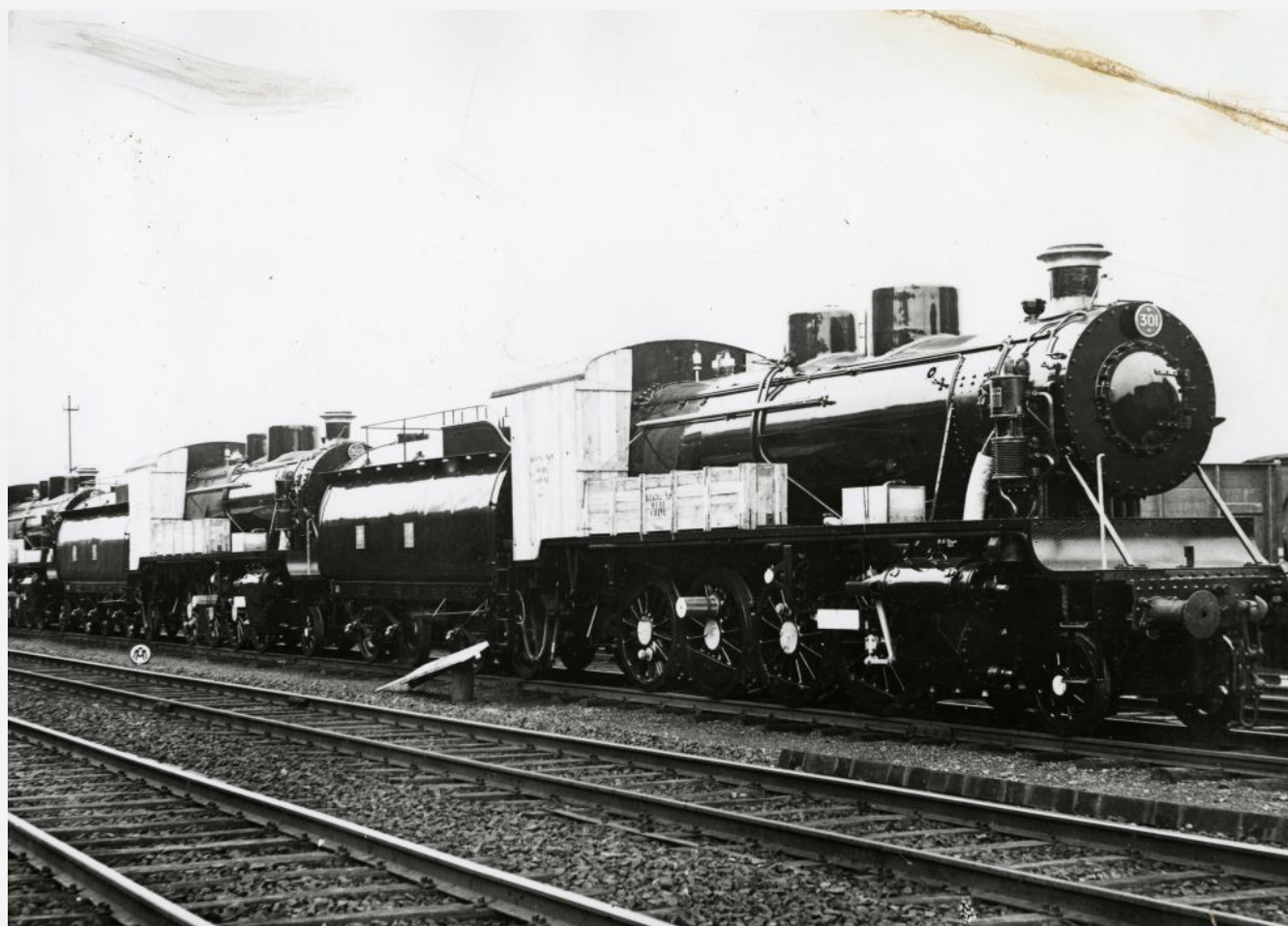
Tubize 2167 de 1934 pour le KiangNan (n° 301), au départ pour la Chine. Photographie d'usine, coll. Musée 'de la Porte' à Tubize. Série 2167-2176, 1934, voie 1.435, 1Dh2 ou 2-8-0, KiangNan 301-310.
