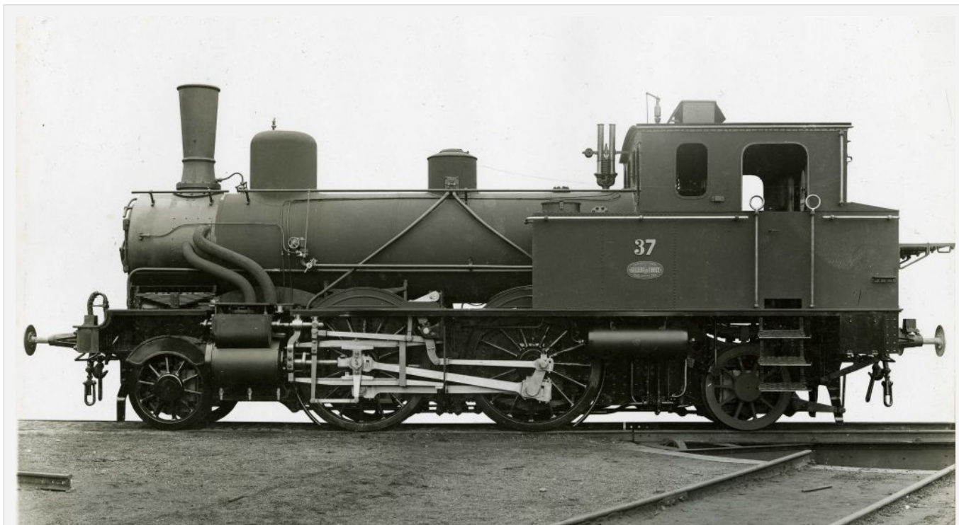
Tubize 1463 de 1905 pour le PH (n° 37). Photographie d'usine, coll. Musée 'de la Porte' à Tubize. Série 1462-1463, 1905, voie 1.435, 1B1n2t ou 2-4-2T, PH 36-37.
