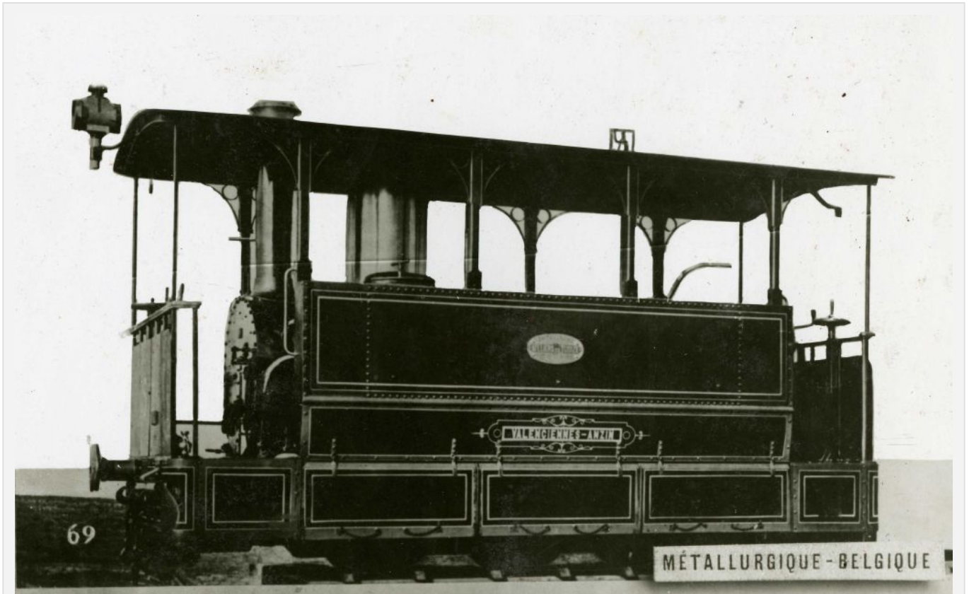
Locomotive tramway du Valenciennes-Anzin construites par les Ateliers de Tubize. Photographie d'usine, coll. Musée 'de la Porte' à Tubize.
